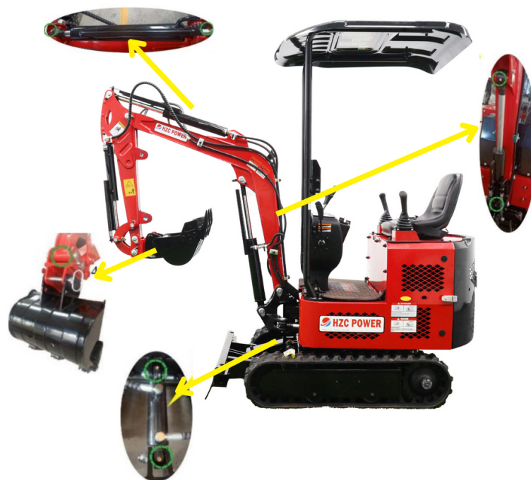
Schmierpunkte am Minibagger.
